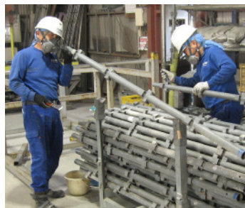
塗装汚れ等をスクレーパーで削ぎ落とす
